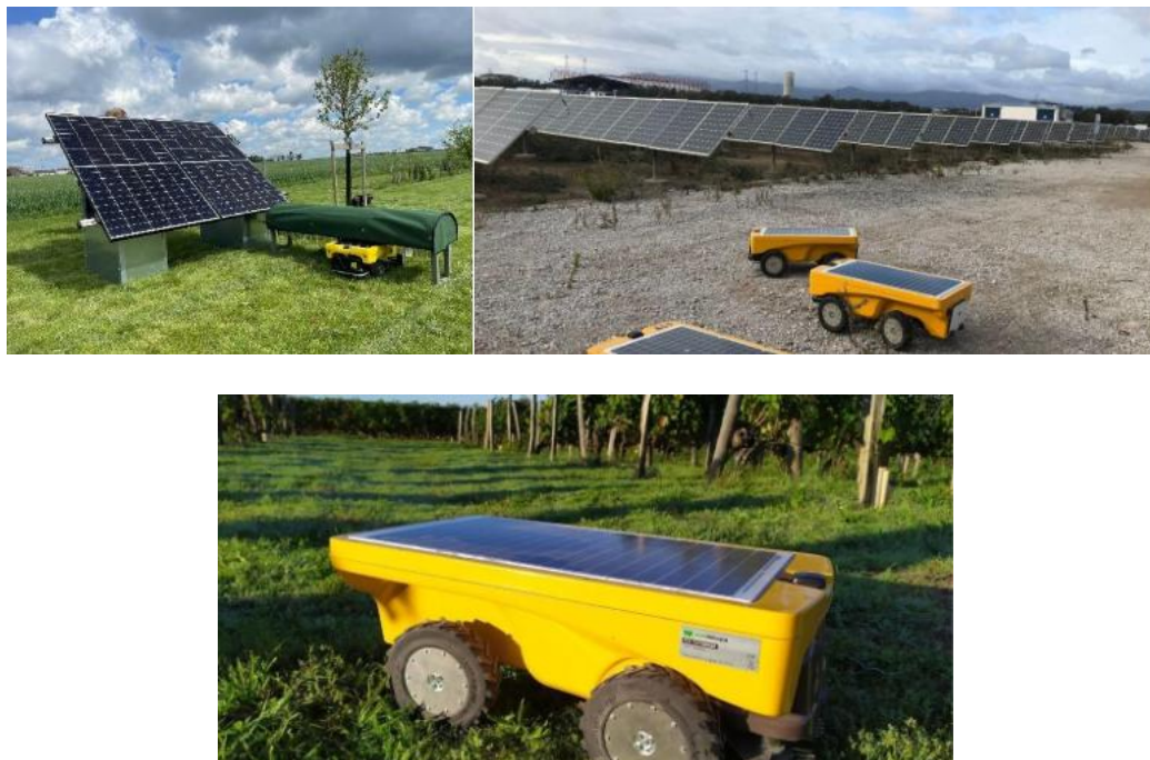
Figure 1 : Robot dédié à l'entretien des parcelles solarisées
