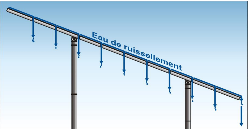
Figure 1. Répartition des panneaux évitant la concentration des eaux (schéma de principe à titre d'exemple)
