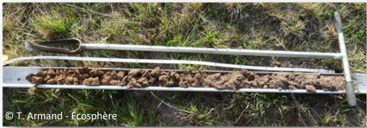
Sondage pédologique à la tarière manuelle
