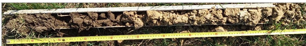
Photo 15 : Profil pédologique d'un CALCOSOL pachique et à traits rédoxiques secondaires (Sondage P9) – Photo prise sur site © Rainette 2025
