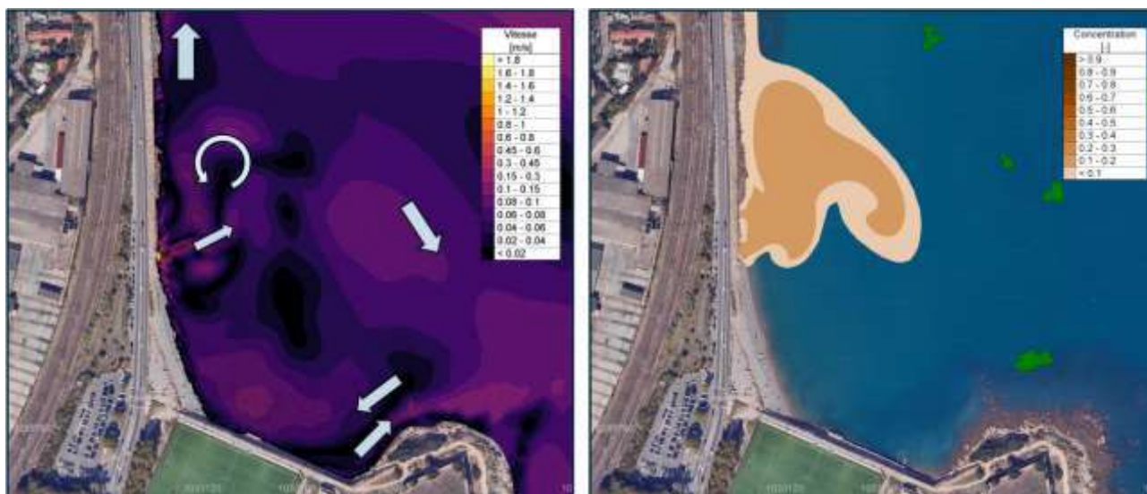
FIGURE 21 - INTENSITE DU COURANT [M/S] ET CONCENTRATION DU PANACHE [-] POUR UNE CONDITION ESTIVALE DE SSO POUR L'OUVRAGE ACTUEL MAIS AVEC UN DEBIT PROJET.
