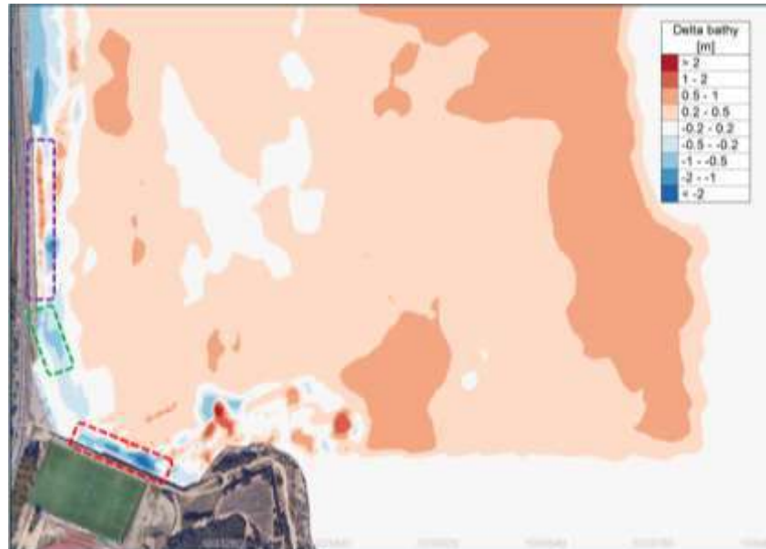
FIGURE 8 - DIFFERENTIEL BATHYMETRIQUE 2023-2015. UNE VALEUR POSITIVE (ROUGE) INDIQUE UNE HAUSSE DU NIVEAU DE FONDS DE 2023 PAR RAPPORT A 2015.
