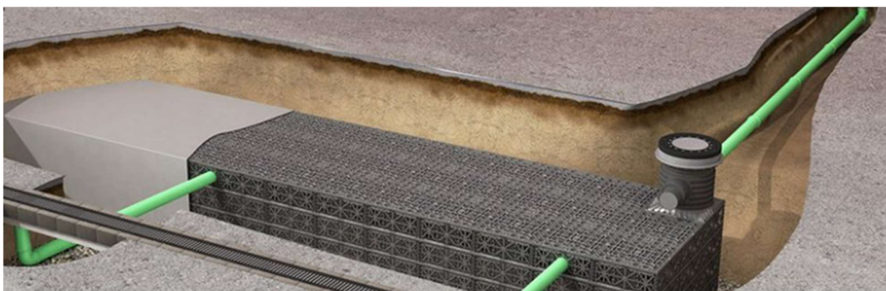
Module de bassin inspectable et hydrocurable pour bassin de rétention des eaux
