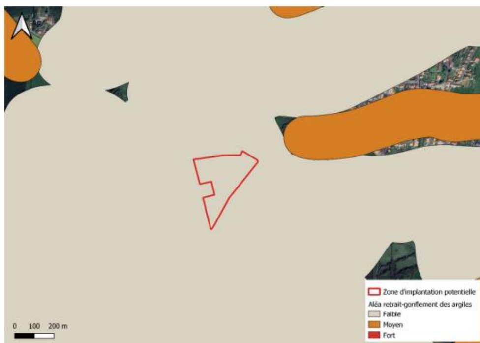
Figure 15 : Extrait de la carte d'exposition au retrait-gonflement des argiles (source : BRGM)
