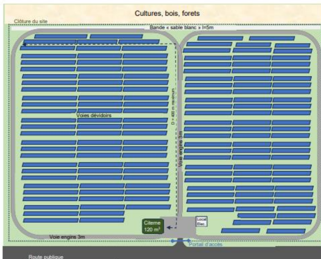
Schéma-type d'un site complet
