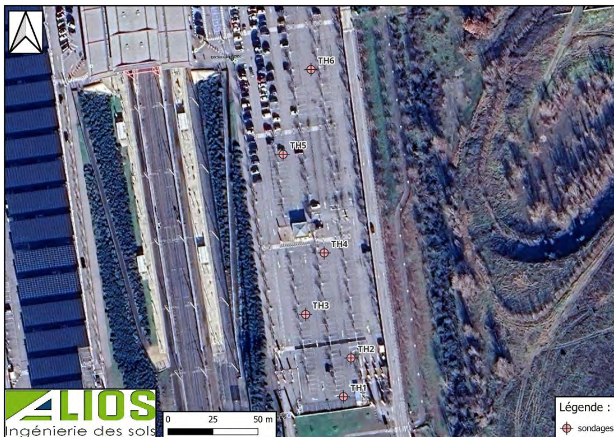
Figure 7: localisation des investigations réalisées par ALIOS
