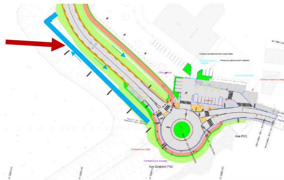
Figure 9: Ecoulement des eaux de la voie verte
