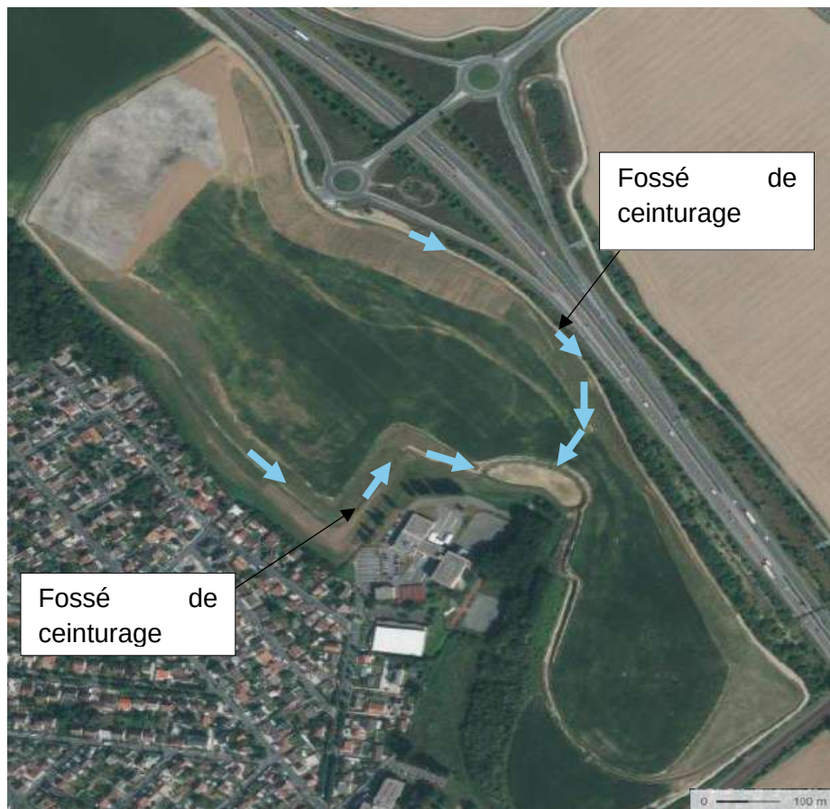
Figure 8: Fonction hydraulique existant
