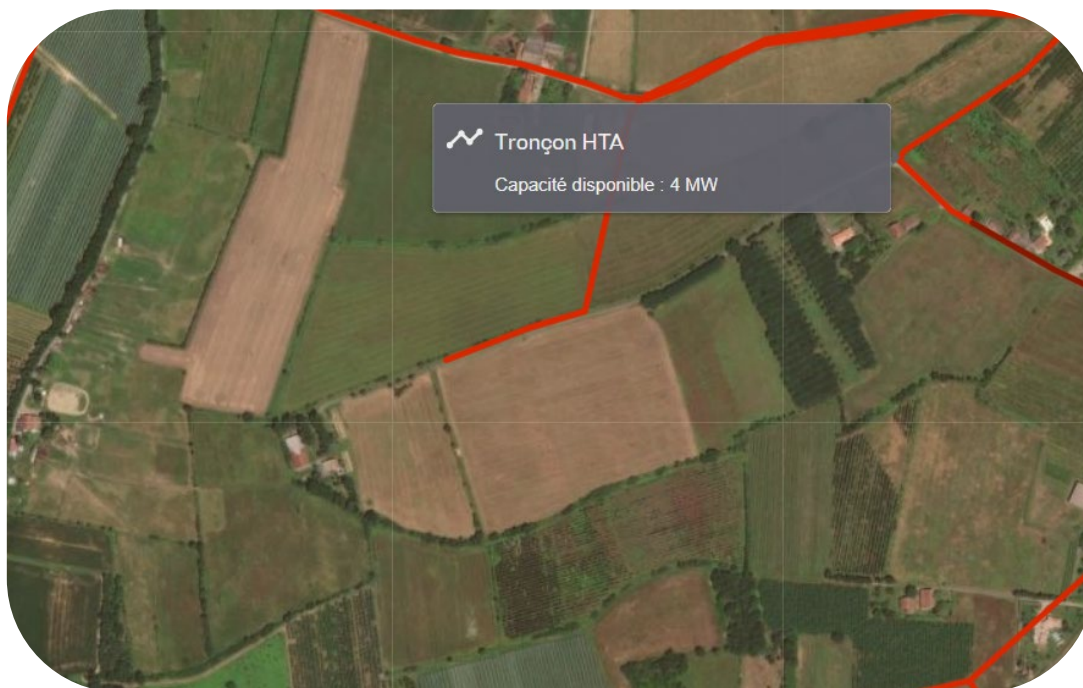
Figure 30 : Capacité disponible sur la ligne HTA de proximité – Source : Enedis
