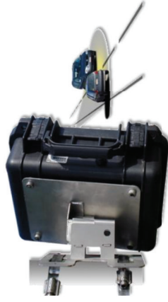
Exemple de capteur radar à détection hors-sol
