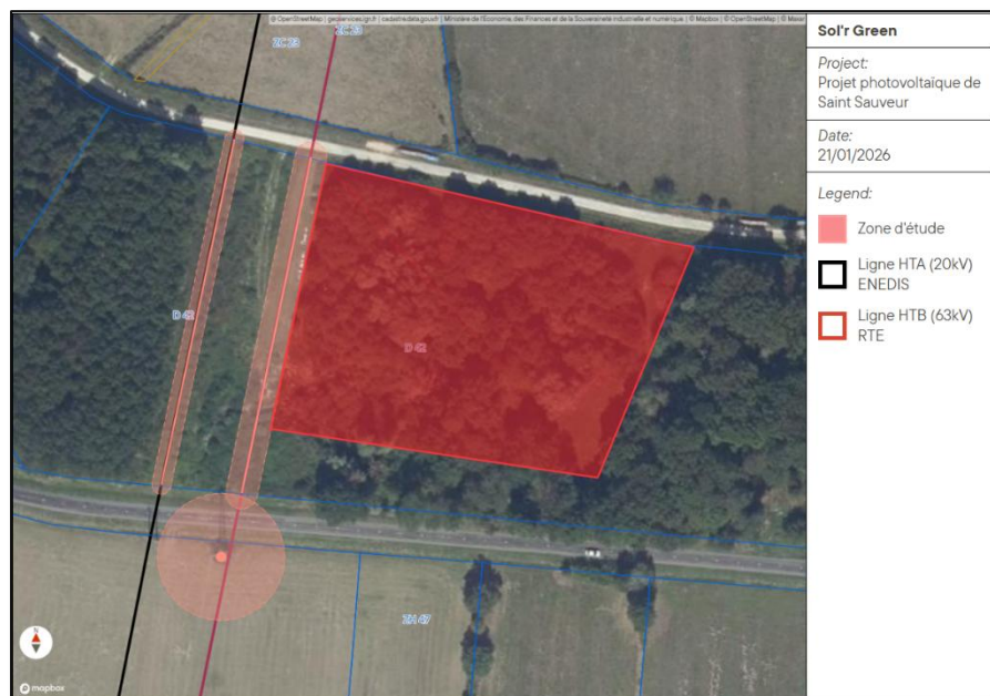
Figure 31 : Lignes électriques aériennes à proximité du site
