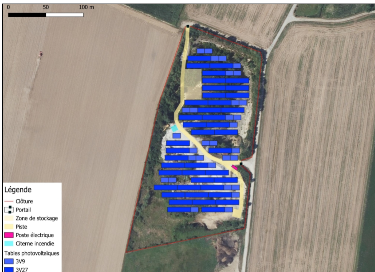
Figure 2: Implantation des installations du projet (source dossier)
