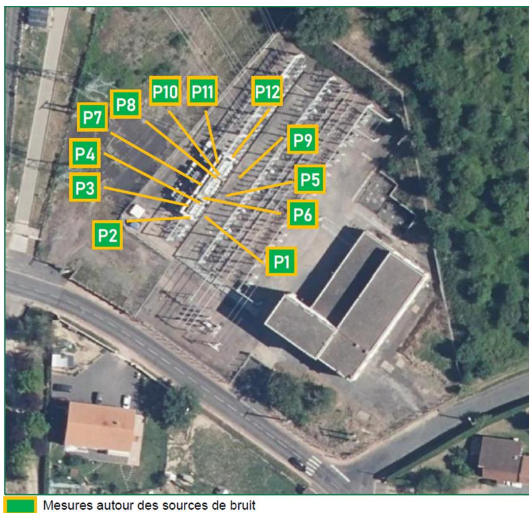
Illustration 18 : Localisation des points de mesures acoustiques autour des transformateurs
