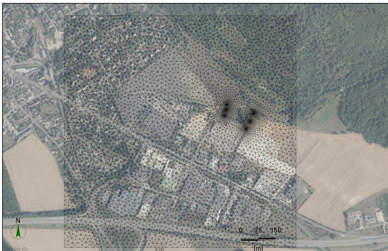
Figure 12 : Maillage triangulaire irrégulier généré par le logiciel FEFLOW
