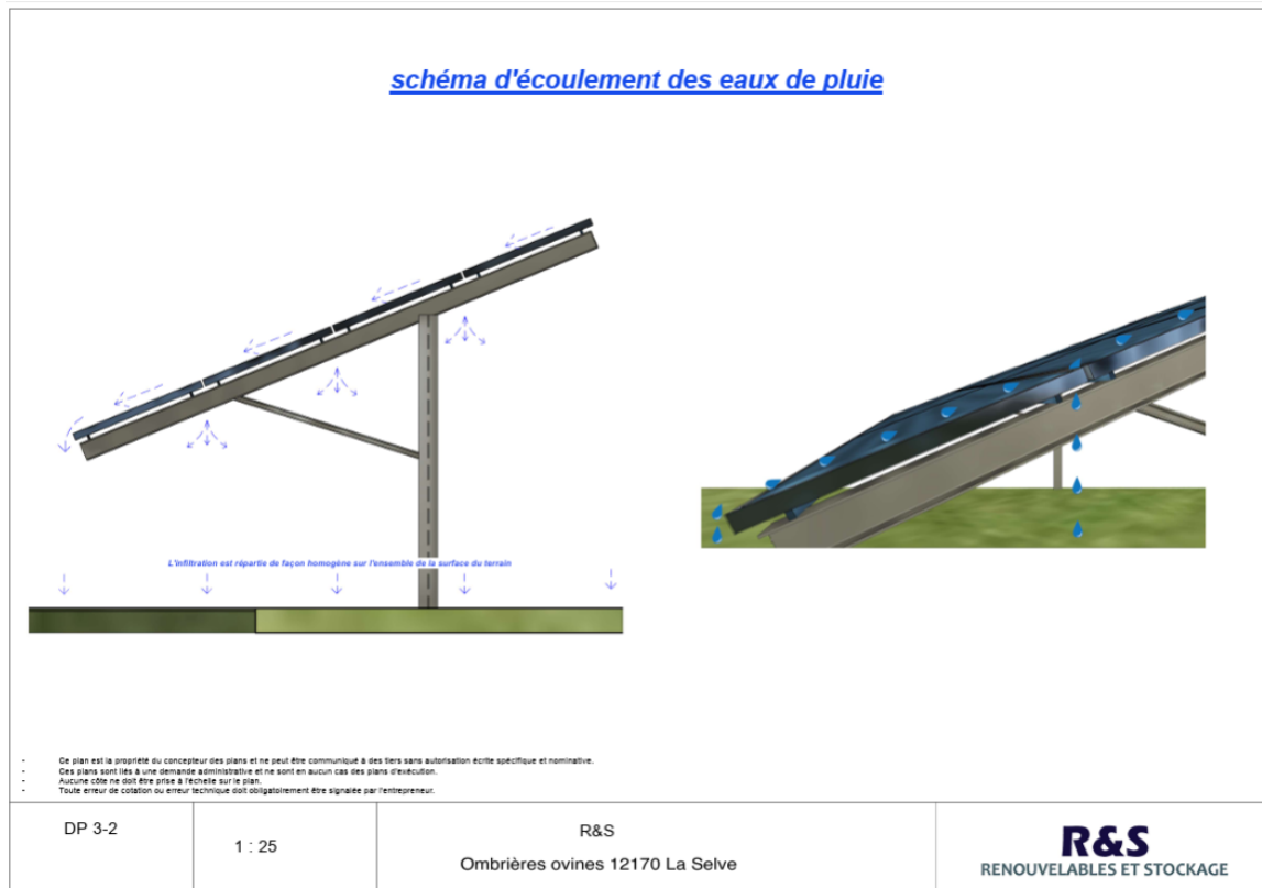
Figure 4 : Ecoulement des eaux de pluie
