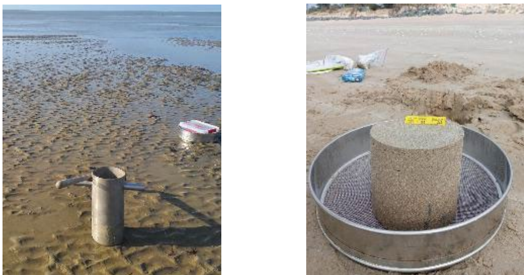
Photo 2-1: Carottier utilisé et prélèvement réalisé annoté
