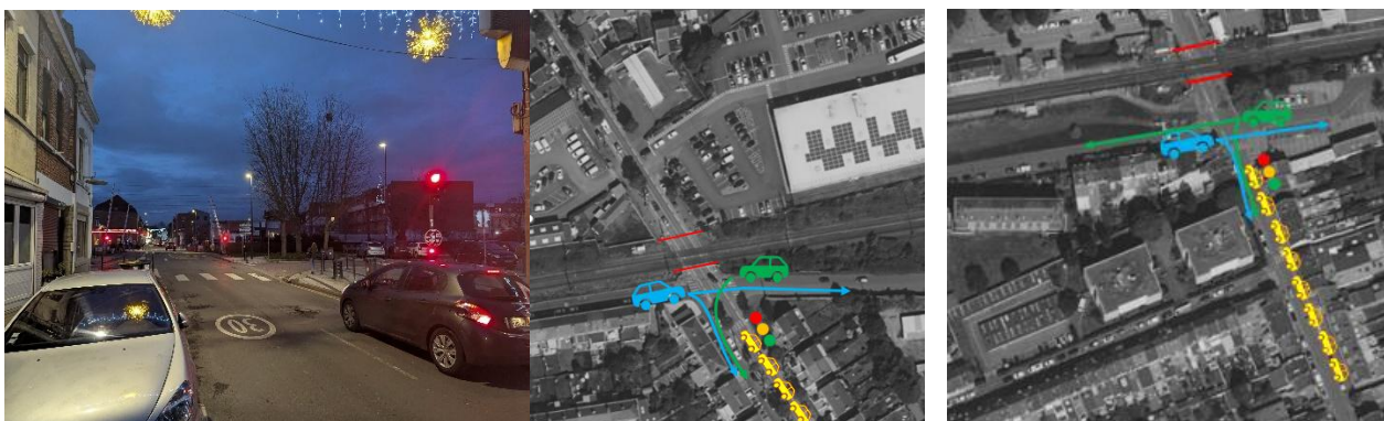
Mouvements facilités par la présence des feux tricolores en amont des passages à niveau (République à gauche – Leclerc à droite)
