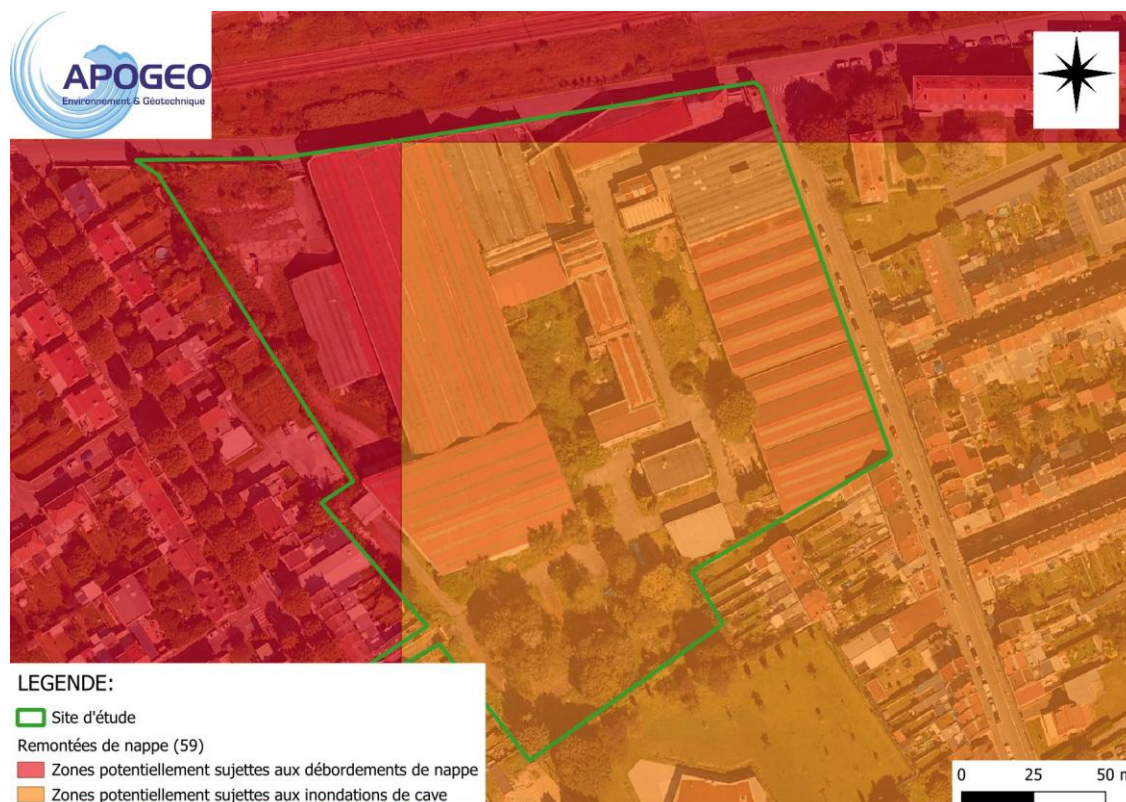
Figure 5 : Aléa inondation par remontées de nappe – GEORISQUES
