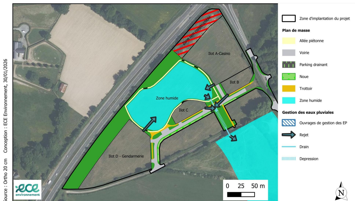
Carte 21 : Principe de rejet des eaux pluviales
