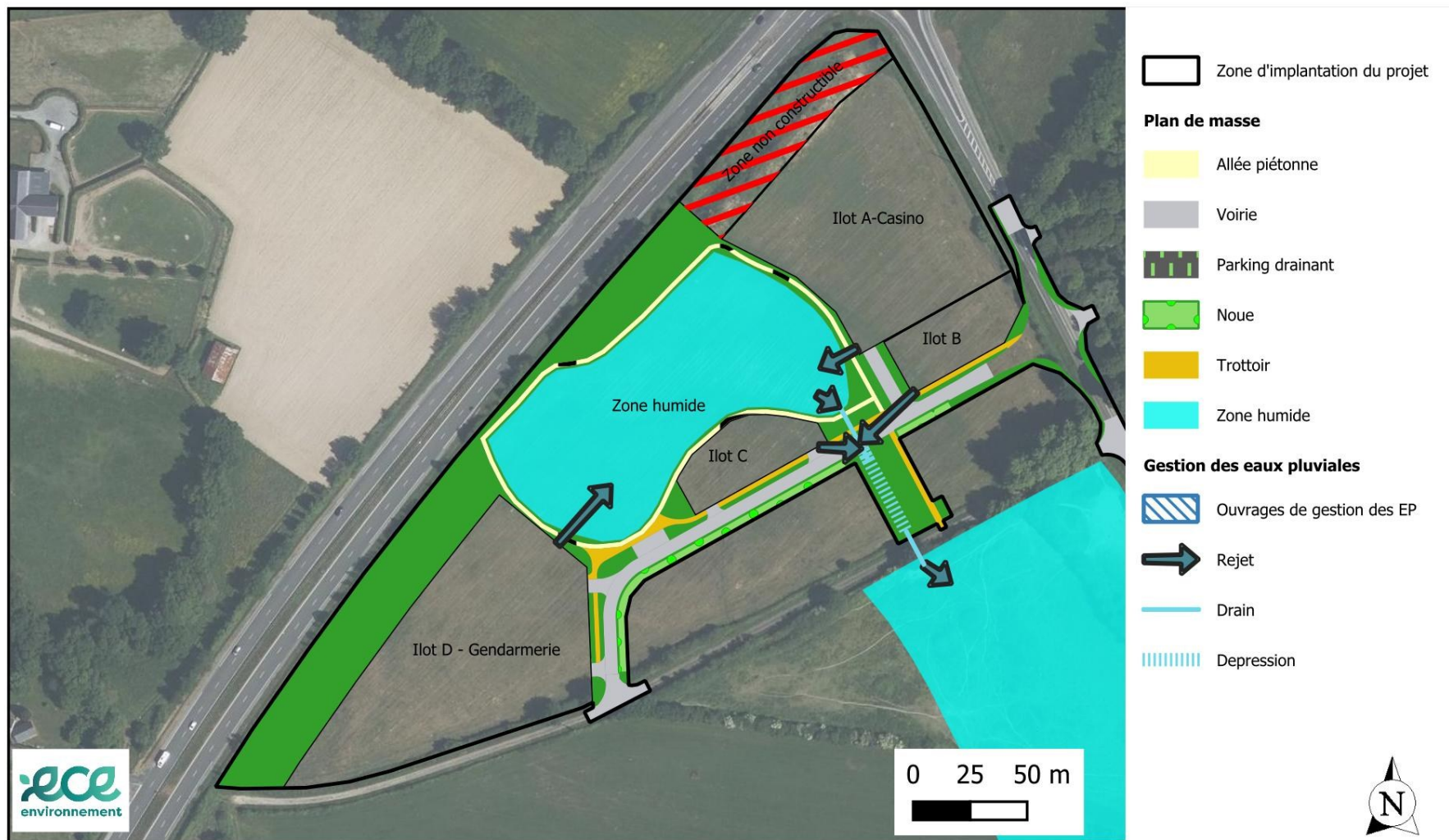
Carte 25 : Principe des points de rejet des eaux pluviales vers la zone humide
