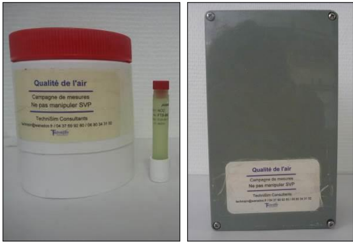
Figure 50 : Réceptacle, tube passif pour le NO 2 et micro-capteur laser pour les particules
