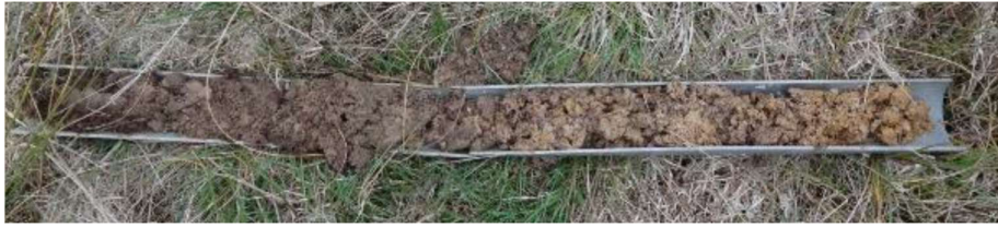
Figure 28 : Exemple d'une carotte de terre réalisée pour donner suite à un sondage
