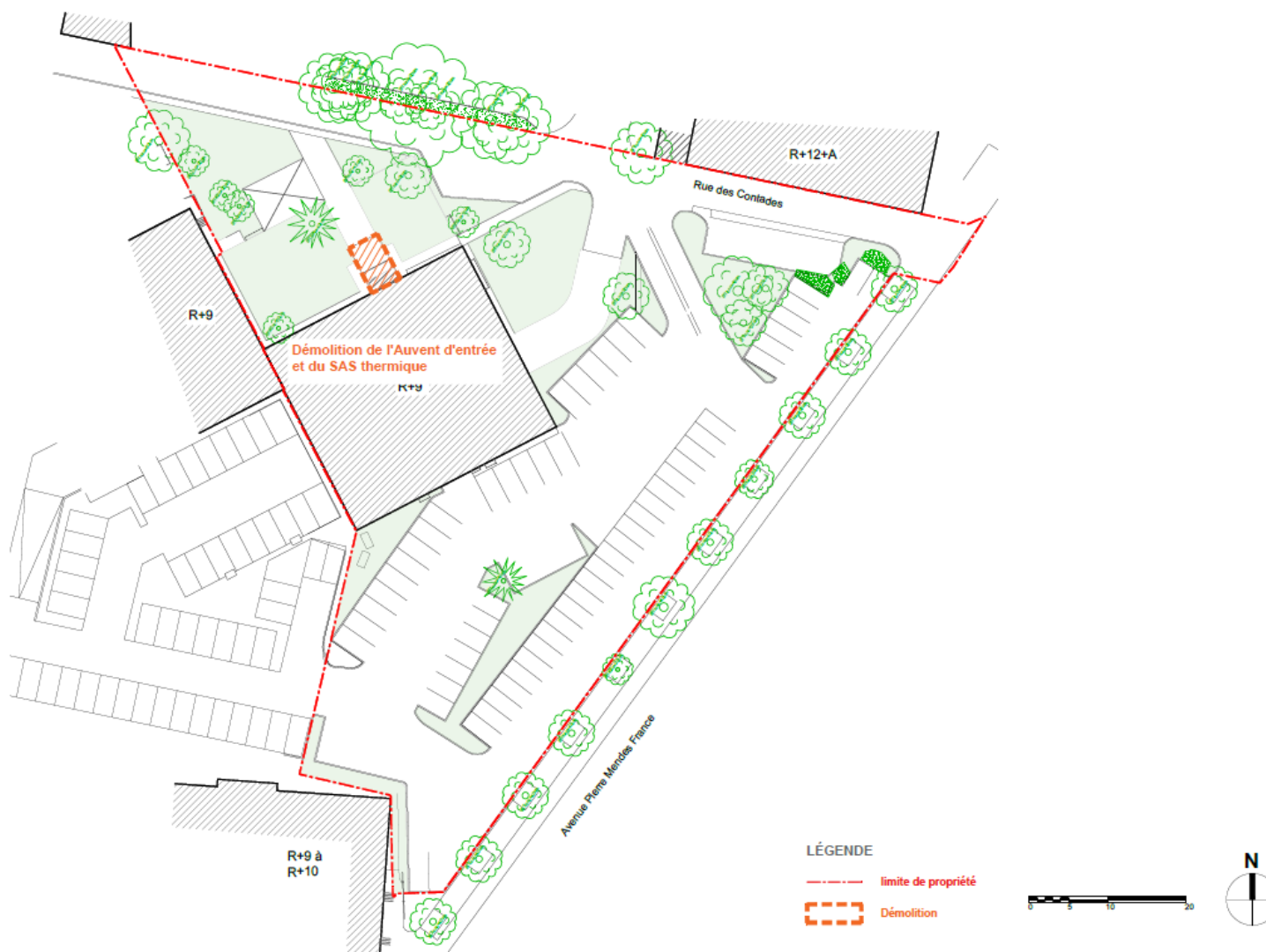
Figure 28 : Démolition prévue dans le cadre du projet – SAS thermique
