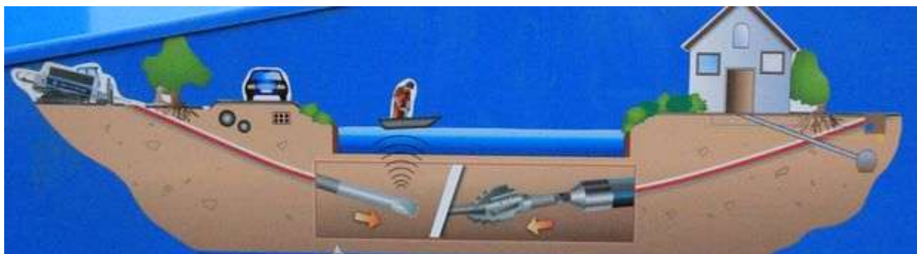
Figure 8 : Schéma de principe d'un forage dirigé
