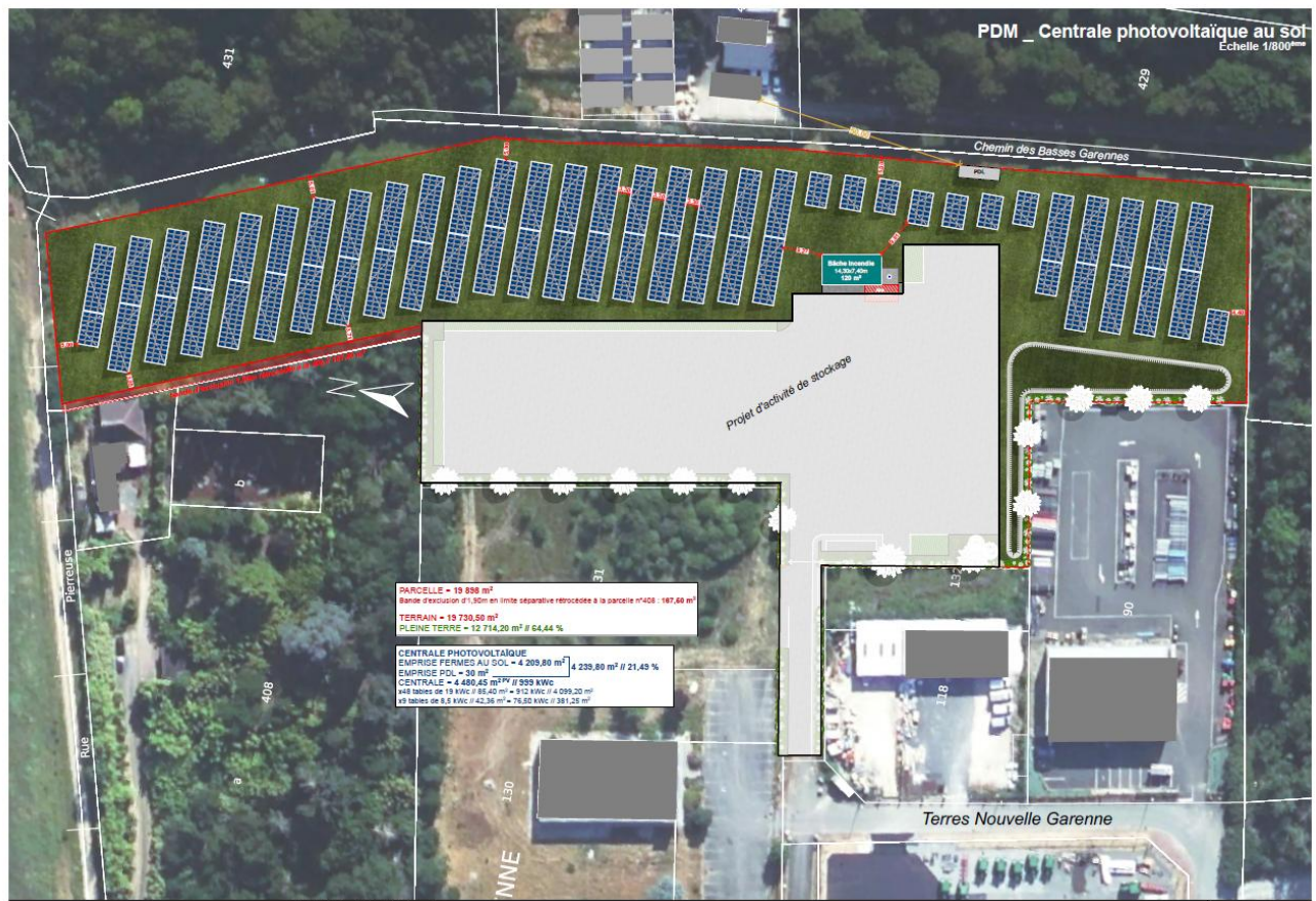
Figure 5 : plan de la centrale photovoltaïque échelle 1/800ème
