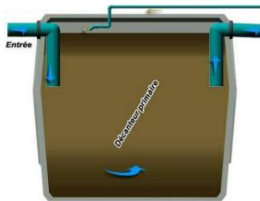
Figure 4 : Le décanteur primaire – Source ELOY – 2024
