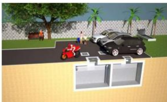
Figure 7 : Exemple d'implantation 3D sous stationnements — Source ELOY – 2024
