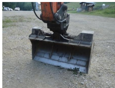
Godet à utiliser pour l'étrépage _KARUM 2019
