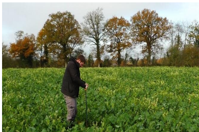
Prélèvement à l'aide d'une tarière pédologique
