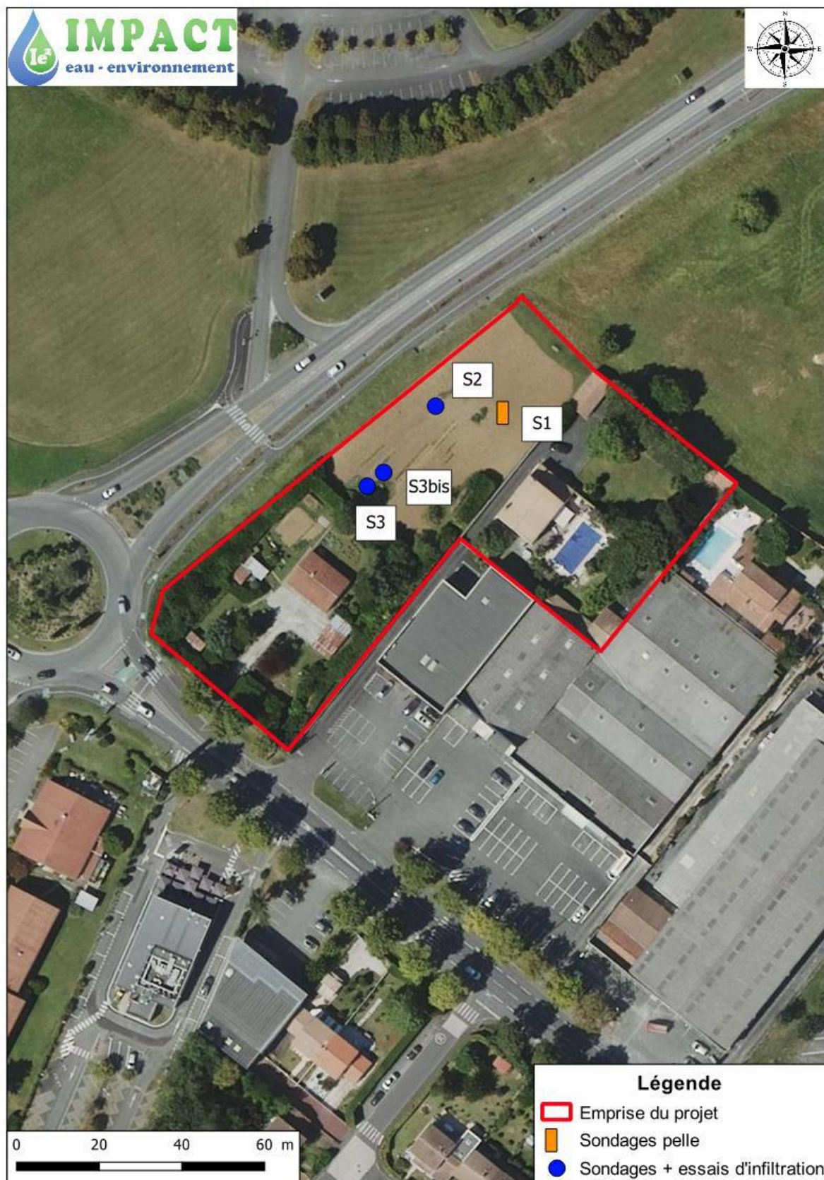
Figure 3. Localisation des sondages et essais de perméabilité
