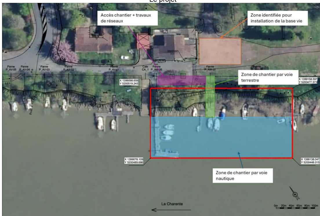
Les emprises de travaux envisagées
