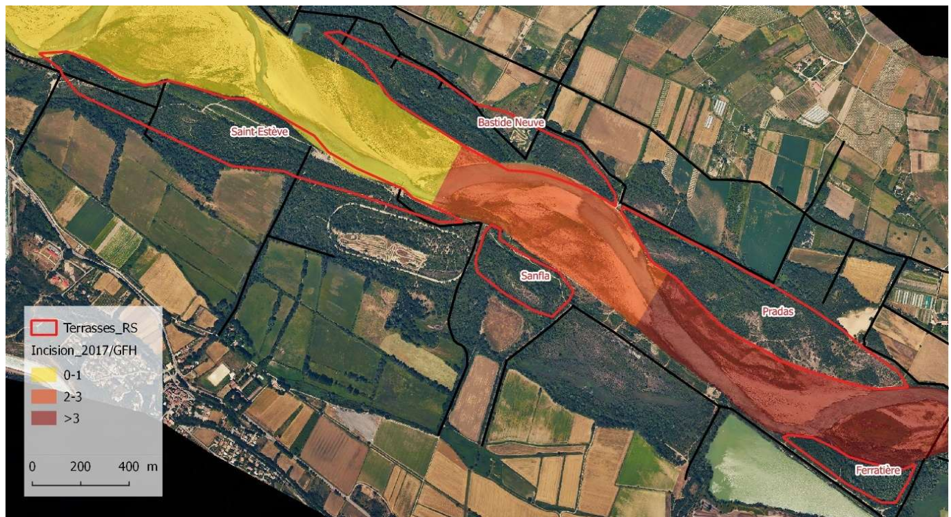
Figure 3: Terrasses latérales analysées sur le secteur de Villelaure, comparaison de l'incision du profil en long d'étiage de 2017 et du profil en long levé par les Grandes Forces Hydrauliques (extrait du rapport d'Etudes préalables : inventaire des sites potentiels et analyse des enjeux ; B0-206 & B0-302 Recharge sédimentaire en Moyenne et Basse Durance, SMAVD 2020)
