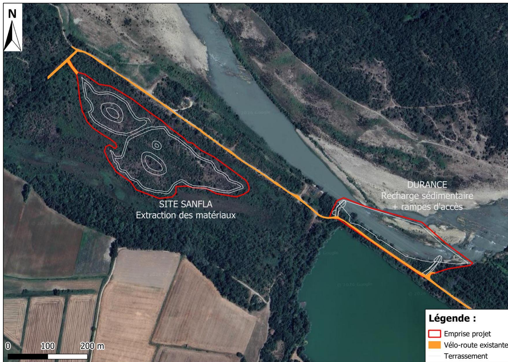
Figure 37 : Zones de terrassement et voie d'accès des engins de chantier entre les deux sites (Source : Google Satellite ; Réalisation : CERAG)
