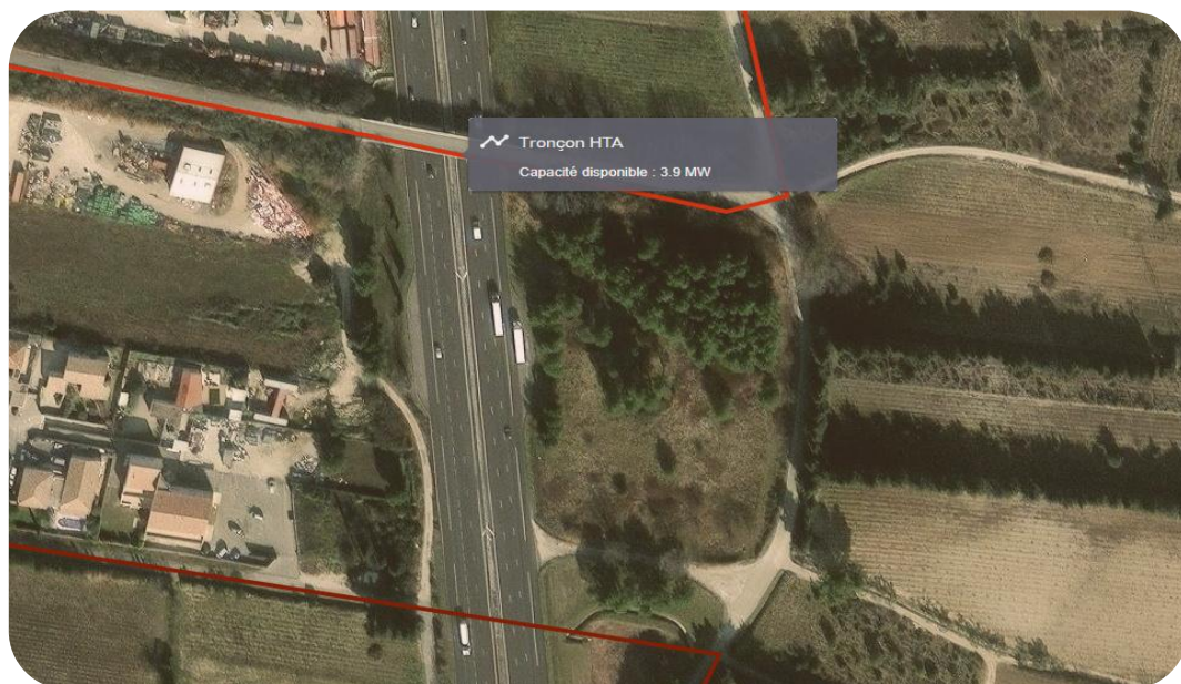
Figure 20 : Capacité disponible sur la ligne HTA de proximité – Source : Enedis
