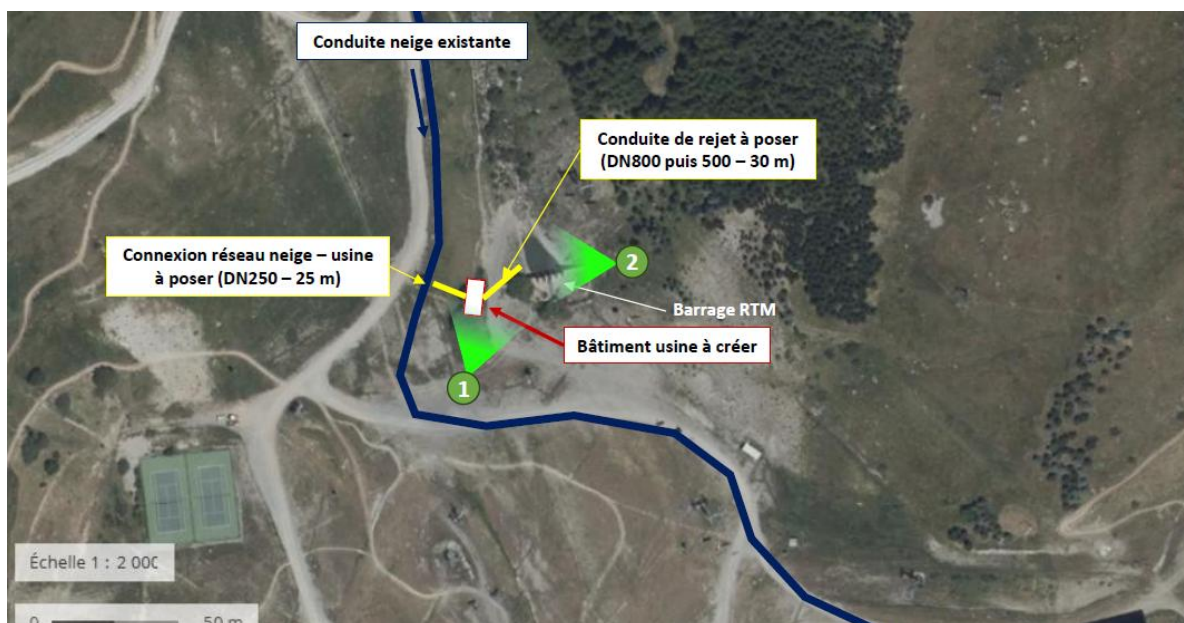
Figure 3 – vue des travaux à mener
