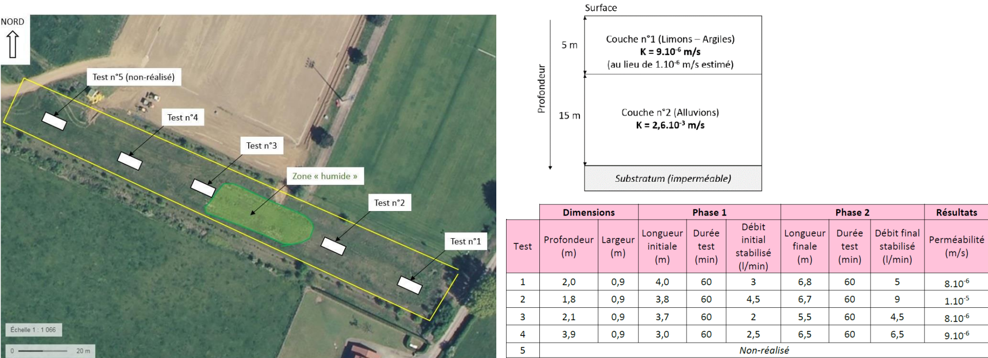
Figure 4 – Résultats des essais d'infiltrations menés sur le bassin en décembre 2019 avec les dimensions des fosses d'infiltrations + schéma conceptuel des perméabilités locales des 2 principales couches (Utilities performance, 2019)
