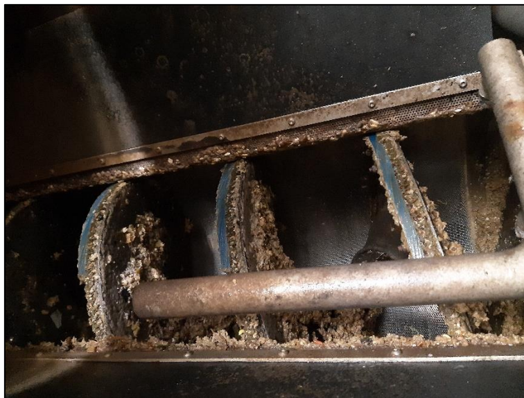
Figure 37 : Grille de tamisage et vis de transport
