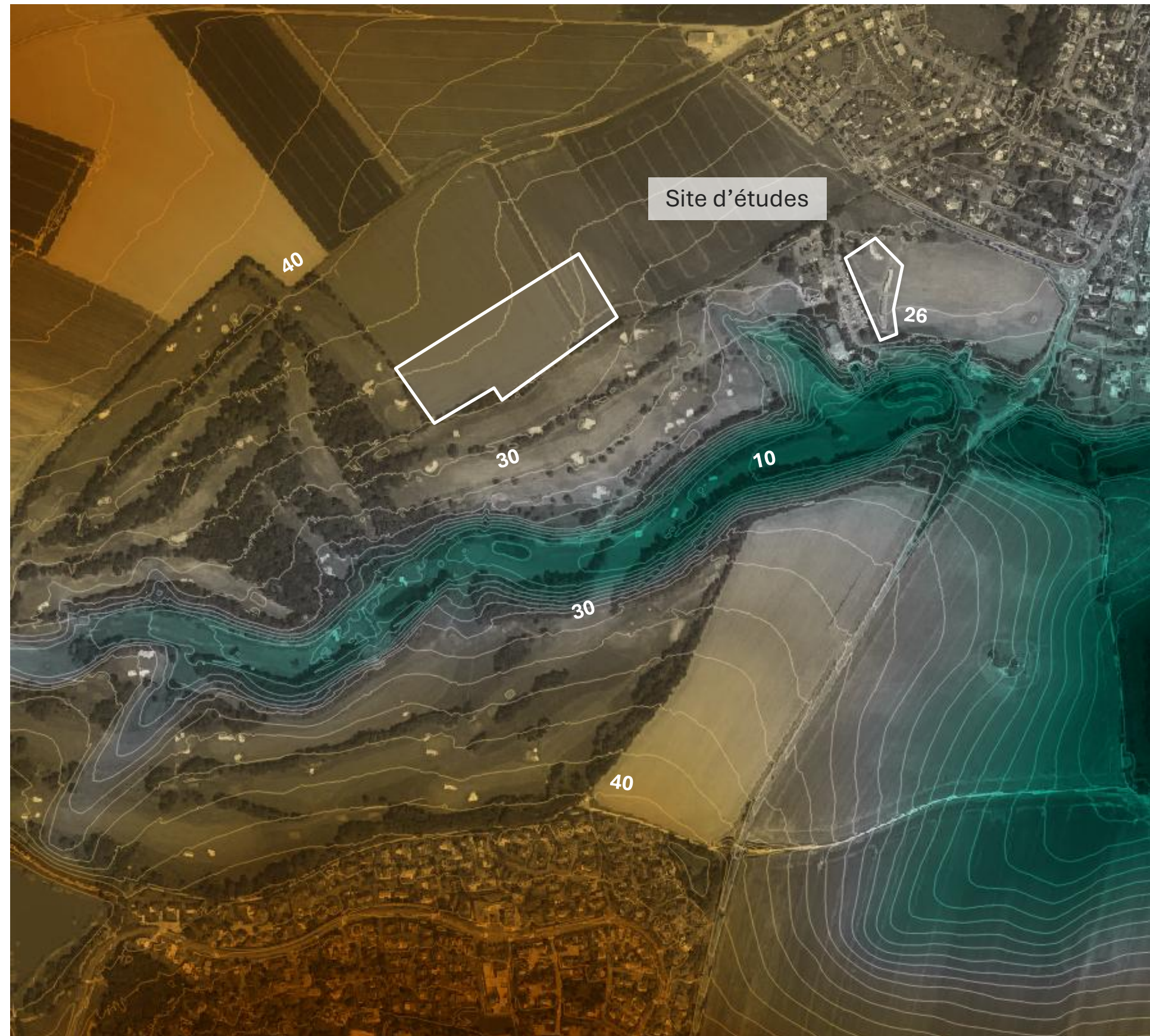
Topographie du site – Courbe de niveau à 2m - LIDAR IGN
