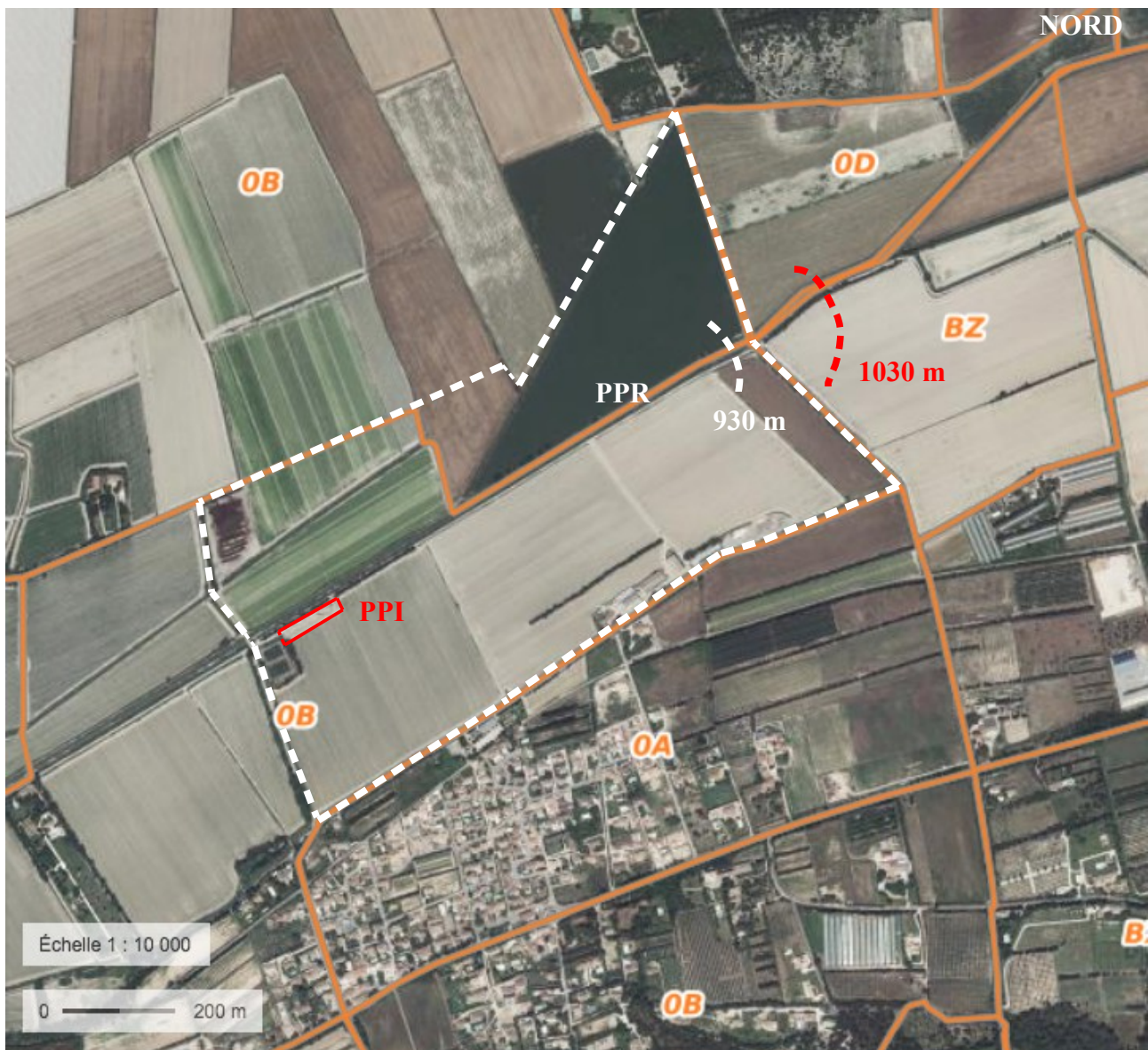
Fig. 13. Délimitation du Périmètre de Protection Rapprochée (PPR) et position de l'isochrone 50 jours selon les méthodes de Whissling (930 m) et Feflow (1030 m).
