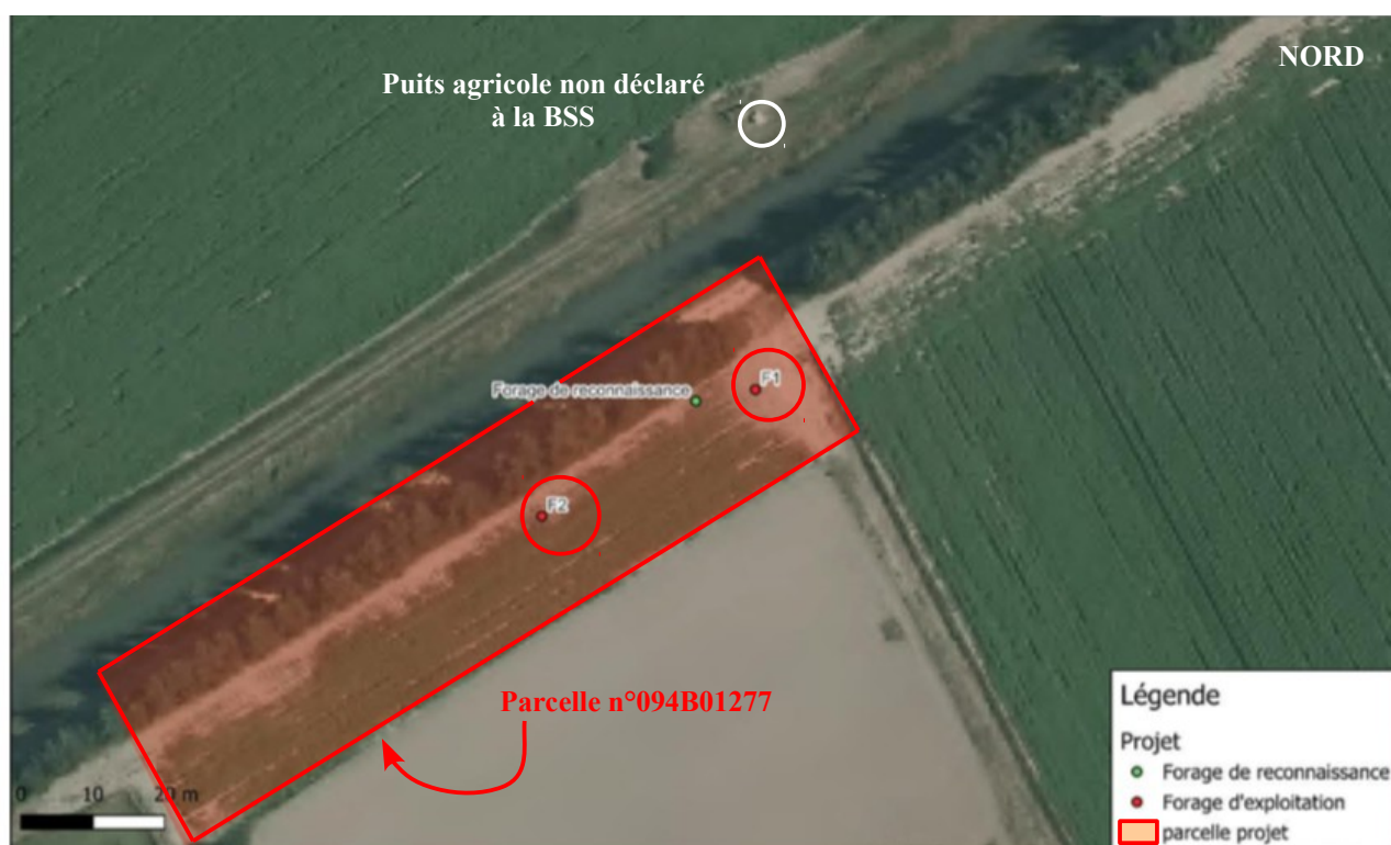
Fig. 2. Situation cadastrale de la parcelle sélectionnée pour l'implantation du nouveau champ captant et position des nouveaux ouvrages (source ANTEA complétée).
