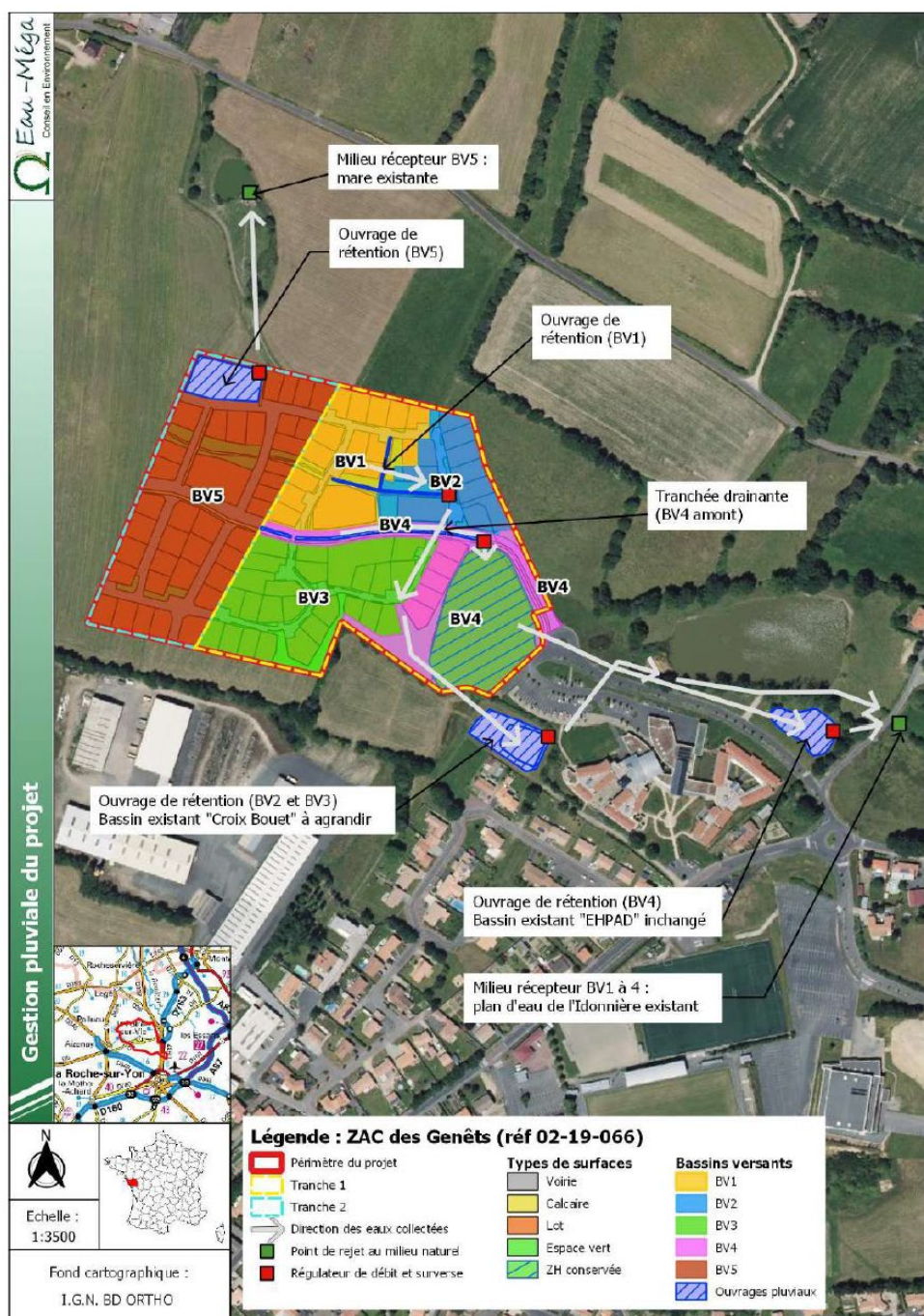
Schéma de fonctionnement global du système de gestion des eaux pluviales (Extrait du DLE, Eau-Méga, Octobre 2020)
