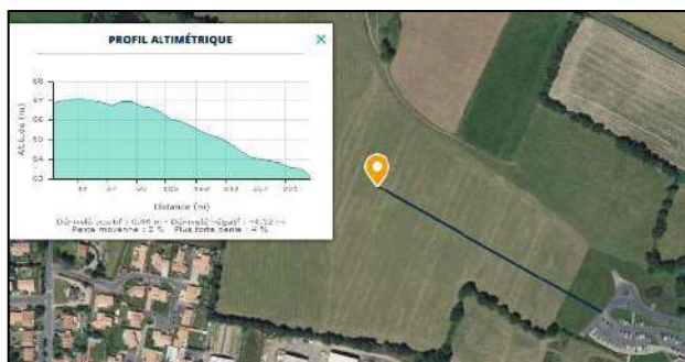
Figure 7. Profil altimétrique de l'aire d'étude
