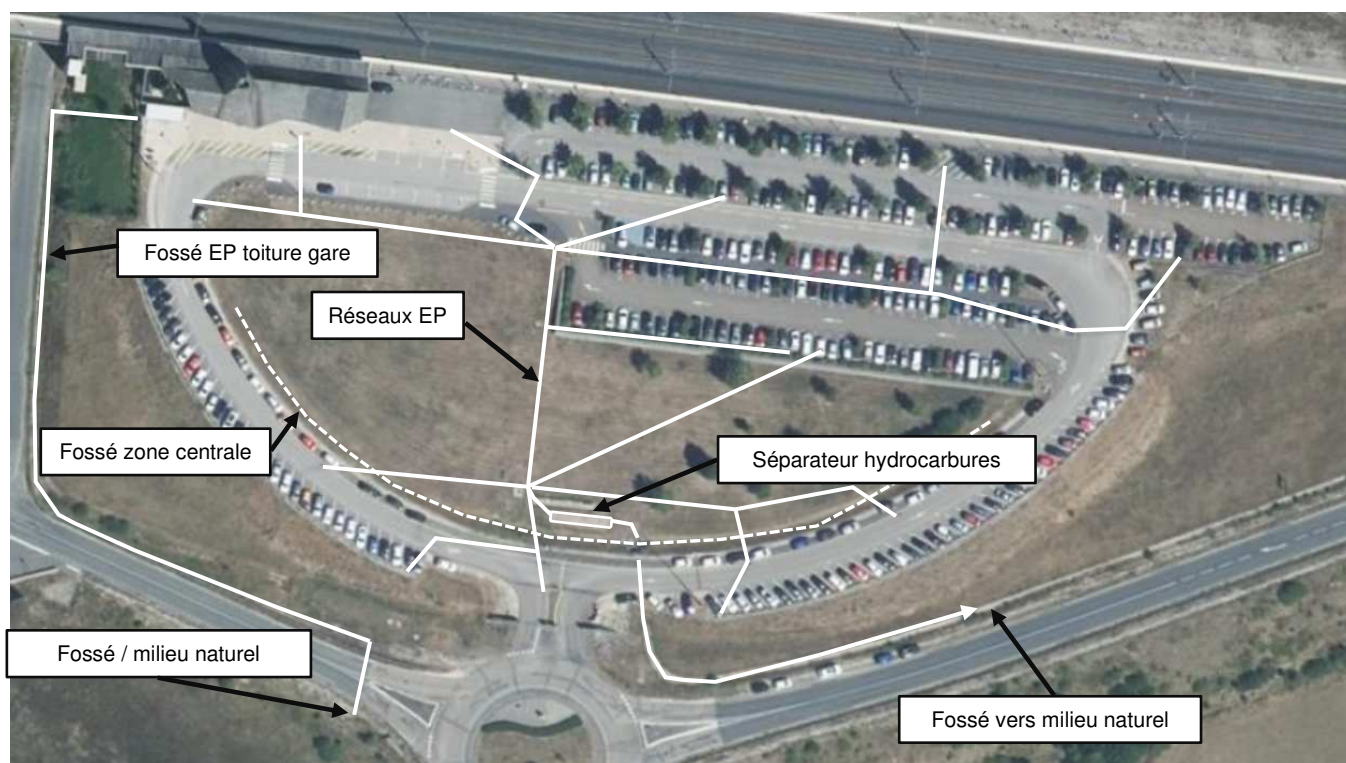
Figure 4 : Schéma du fonctionnement hydraulique du site
