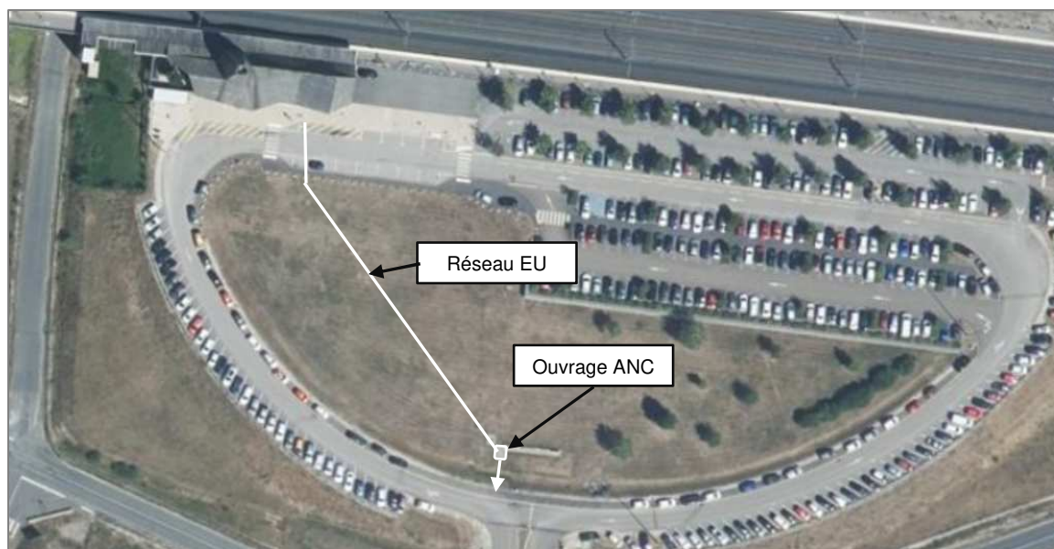
Figure 12 : Localisation de l'ouvrage d'ANC
