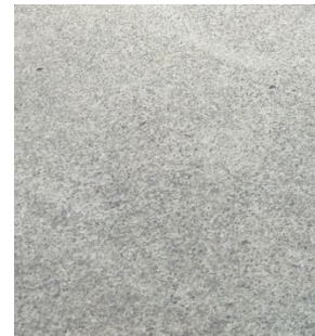
Béton désactivé cailloux gris
