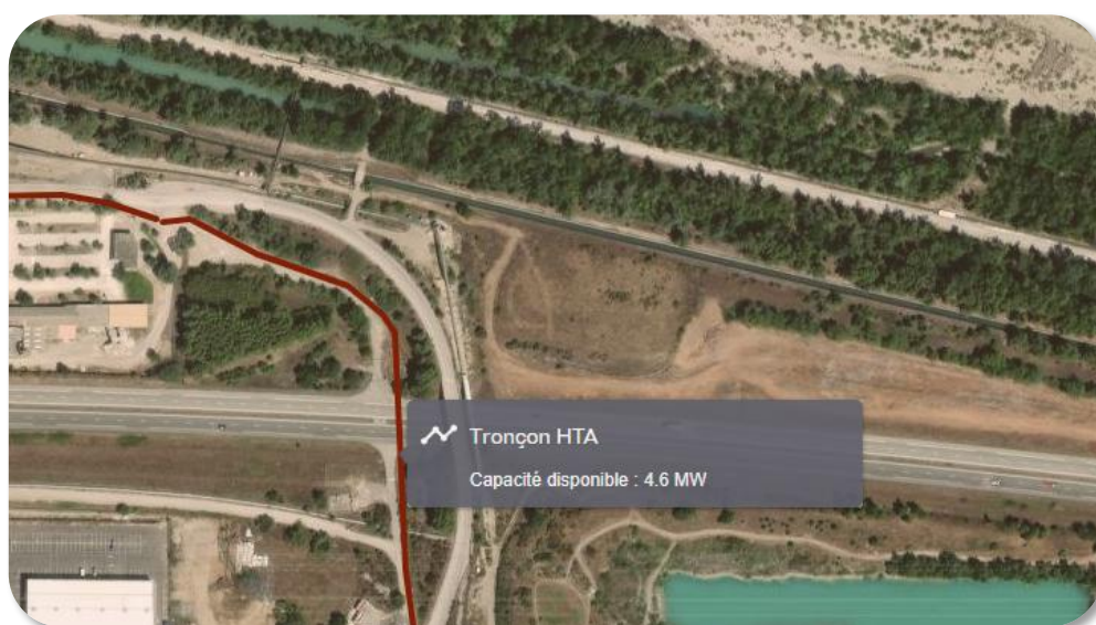
Figure 20 : Capacité disponible sur le poste électrique HTA de proximité – Source : Enedis
