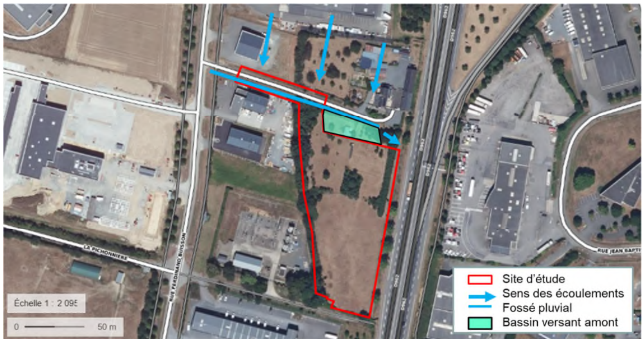
Figure 3 : Définition du bassin-versant amont
