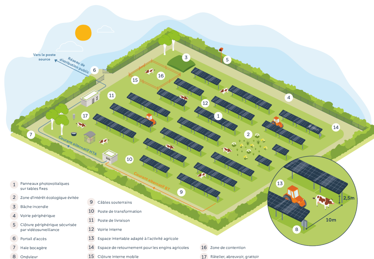
Schématisme d'un parc d'ombrières agrivoltaïques en co-usage avec élevage bovin
