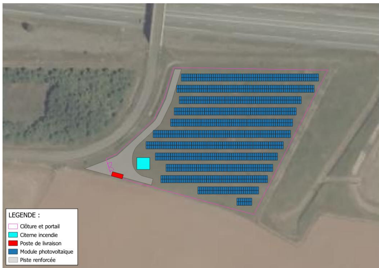
Figure 3 : Aménagement de la centrale solaire
