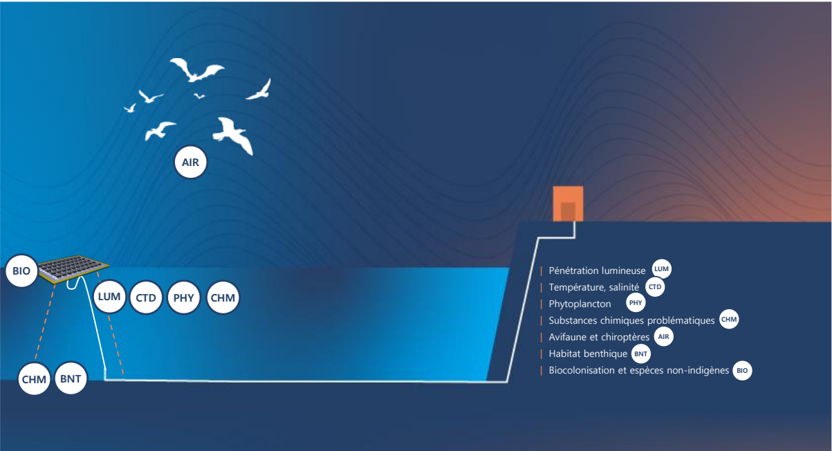
Figure 16. Schéma conceptuel du suivi environnemental du projet de plateforme photovoltaïque SOFLOCEAN en essais pour 12 mois dans les bassins ouest du GPMM
