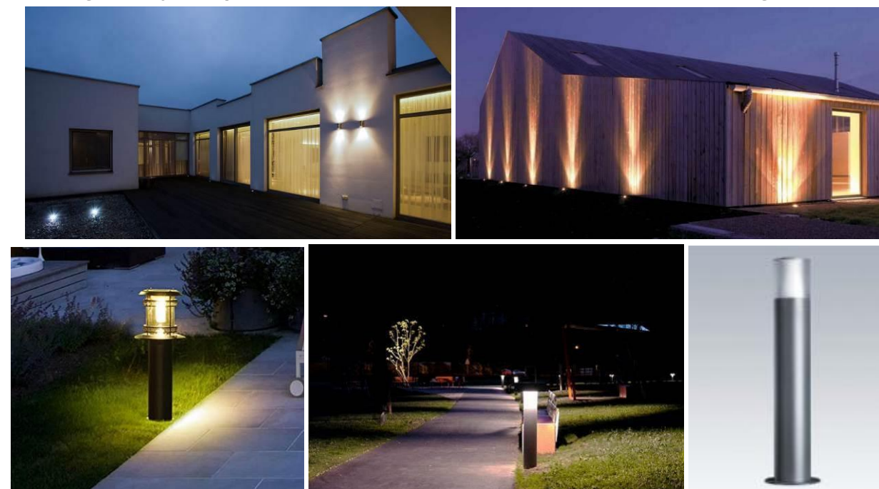
Types de bornes à proscrire : plus de 50% de la surface éclairée n'est pas utile, génère de la pollution lumineuse inutile
