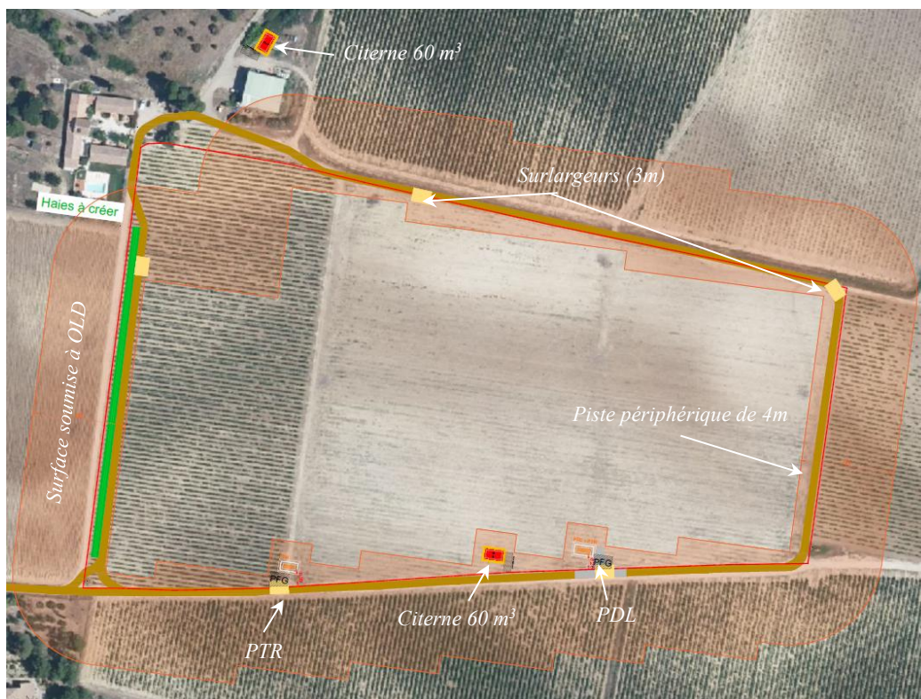
Mesures DECI autour de la structure agrivoltaïque (Source : Sun'Agri)
