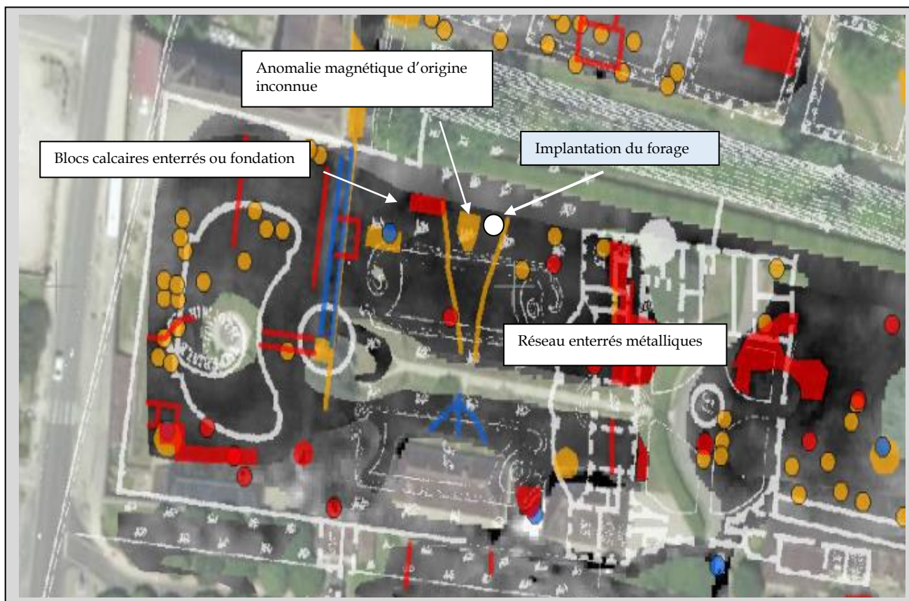
Illustration 13 Carte d'interprétation et de résistivité avec superposition du plan de 1760 ; Position du forage F1 en projet
